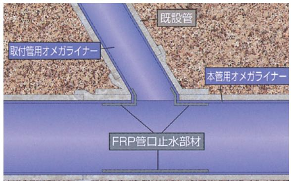
取付管と本管の接合部にFRP製の止水部材を接着することにより、本管と取付管の間の水密性を確保!
