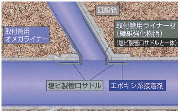
本管側は塩ビ製サドル、取付管側はサドルと一緒にした繊維強化樹脂製ライナー材による止水を行うことで、管口部分への形状追随性、止水性、施工性が大幅向上!
