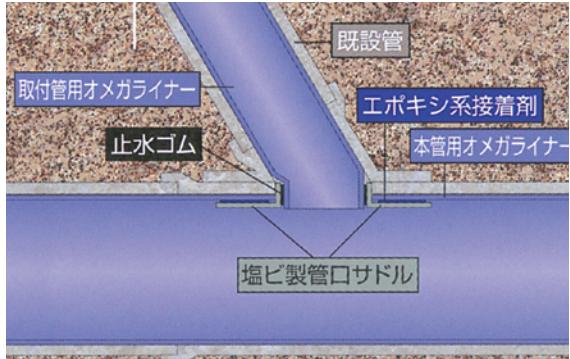
本管との接続部は塩ビ製サドルと止水ゴムで一体化することにより高い水密性を発揮。オール塩ビでの更生が可能。
